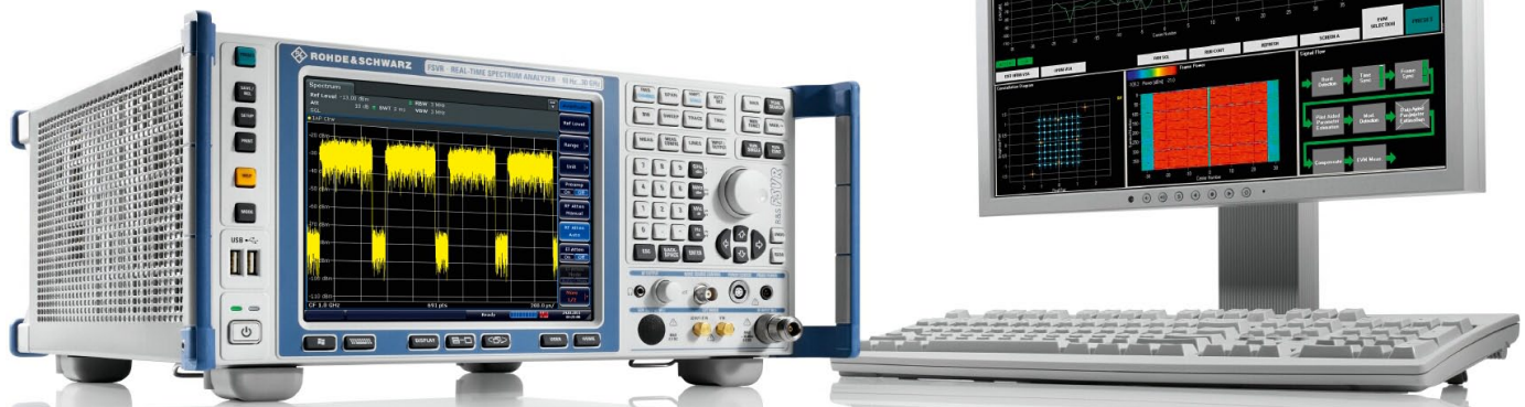
BILD 1 Die Software R&S®FS-K96 kann mit verschiedenen Spektrumanalysatoren von Rohde&Schwarz (hier mit dem R&S®FSVR) verwendet werden und steuert diese per LAN oder GPIB.
